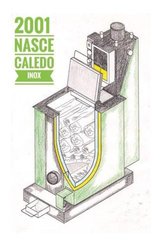
CALEDO INOX nasceva nel 2001 dopo un importante progetto di ricerca della Regione Piemonte – "LEGNO ENERGIA 2000" (gestito dalla I.P.L.A. di Torino) come caldaia "indistruttibile ed inarrestabile". Costruita in ACCIAO INOX a gestione elettromeccanica, con un sistema di combustione che sfruttava principi innovativi, ispirati a quelli dei gasogeni da autotrazione ed a quelli delle carbonaie per la produzione del carbone vegetale.
